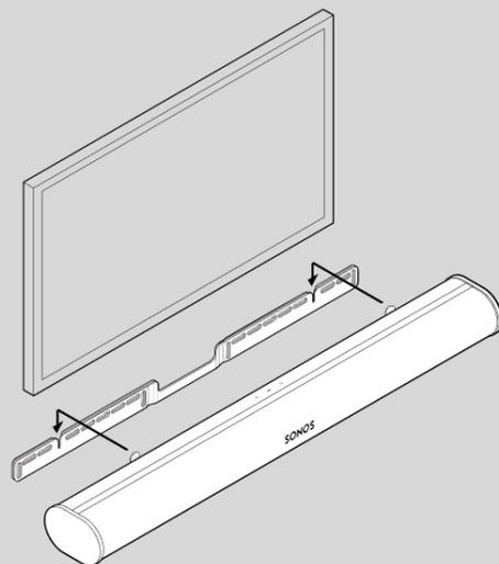
7. Schieb die Soundbar nach unten, sodass die Knöpfe in die Schlitze der Wandhalterung gleiten. Vergewissere dich, dass die Touch-Bedienelemente nach oben zeigen und die Soundbar richtig fest sitzt.
