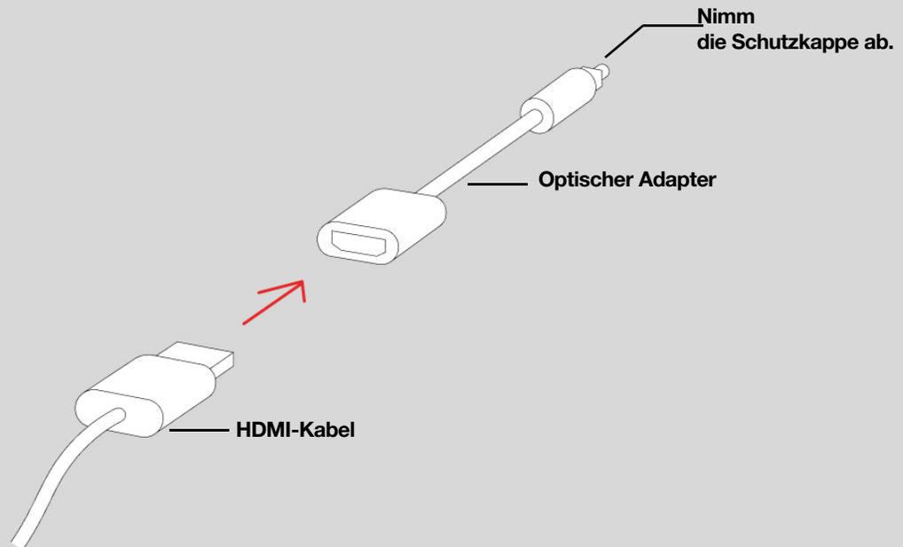
3. SchlieÙe den optischen Adapter an den **optischen digitalen Ausgang** des Fernsehers an.
