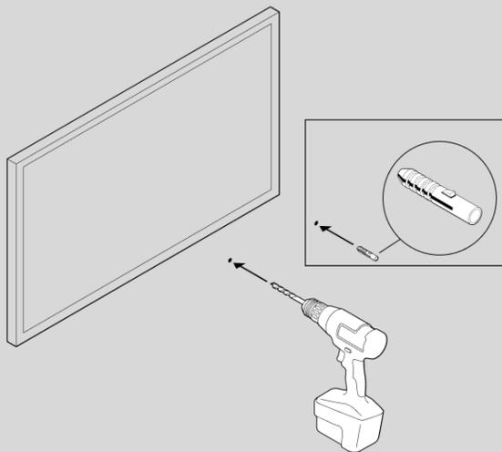
3. Beim Einsatz der mitgelieferten Dübel verwende zum Vorbohren der Löcher einen 8-mm-Bohrer und setze anschließend die Dübel ein. Verwende die Dübel nicht, wenn du in Holz oder Plastik bohrst.
