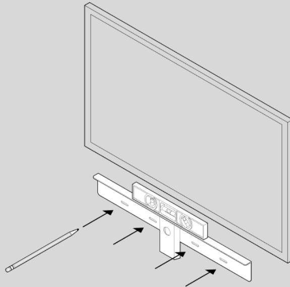
3. Verwende zum Vorbohren der Löcher einen 8-mm-Bohrer (siehe **Informationen zur Wandmontage**).
