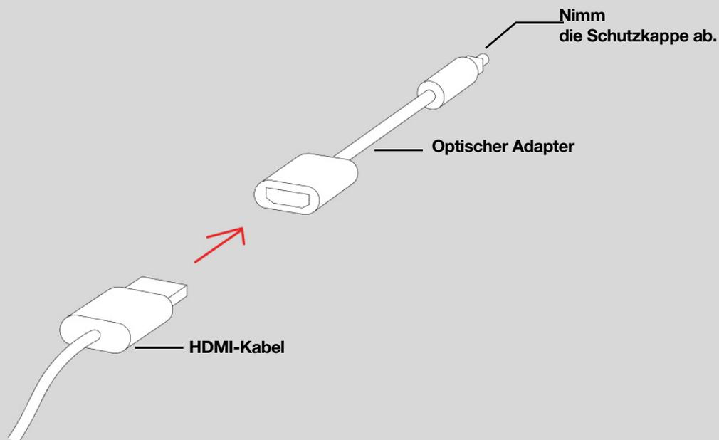
3. Schließe den optischen Adapter an den **optischen digitalen Ausgang** des Fernsehers an.
