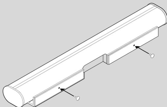
5. Schraube die zwei Knöpfe in die Rückseite der Soundbar, bis sie fest angezogen sind.
