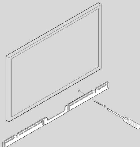
4. Platziere die Wandhalterung über die Markierungen für die Schrauben und vergewissere dich mit einer Wasserwaage, dass sie gerade ist. Verwende einen Kreuzschlitzschraubenzieher oder einen Schnellschrauber, um die Halterung an der Wand zu befestigen. Achte dabei darauf, dass die Pfeile in der Mitte nach oben zeigen.
