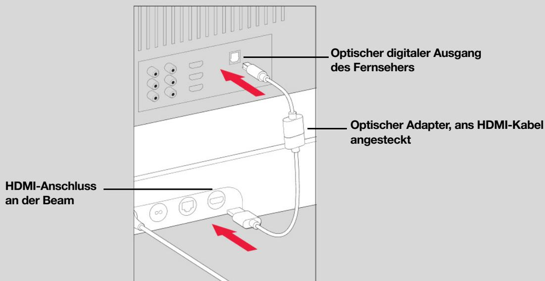
**Hinweis:** Der Anschluss des optischen Adapters ist „D-förmig“. Achte darauf, dass der Stecker richtig ausgerichtet ist. Durch ein verkehrtes Einstecken des Adapters kann das Kabel beschädigt werden.
