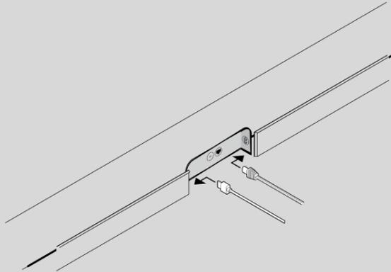
6. Verbinde das Strom- und HDMI-Kabel mit der Rückseite der Soundbar.
