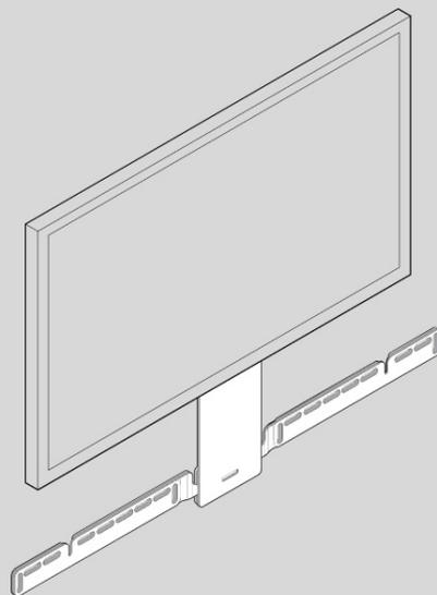
1. Wenn dein Fernseher an der Wand angebracht ist, halte die Positionierungshilfe gegen die Wand und richte ihre Oberkante mit der Unterseite deines Fernsehers aus. Du solltest 14 cm Platz lassen zwischen der Halterung für Wandmontage und dem Fernseher.
