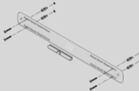
6. Setze die Halterung auf die Wand und ziehe die Schrauben locker an, um die Halterung zu befestigen. Überprüfe mithilfe einer Wasserwaage und ziehe die Schrauben dann fest an.
