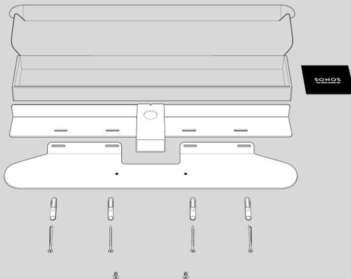
1. Klebe die Pappschablone mithilfe eines Klebebandes ober- oder unterhalb deines Fernsehers an die Wand. Nimm hierzu eine Wasserwaage zu Hilfe. Lasse mindestens 25 mm Platz, um an die Touch Steuerelemente der Beam zu gelangen. (Montiere die Beam nicht senkrecht.)
