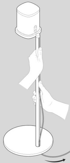
7. Neige den Ständer leicht nach vorne, um das überschüssige Stromkabel um die Sockelunterseite zu wickeln. Verbinde das Stromkabel des Lautsprechers anschließend mit der Steckdose – fertig. Jetzt heißt es: Musik genießen!
