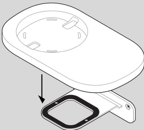
5. Führe das Stromkabel des Lautsprechers durch die Regalöffnung. (Nach Abschluss der Montage wird das Kabel um die Regalunterseite gewickelt.)
