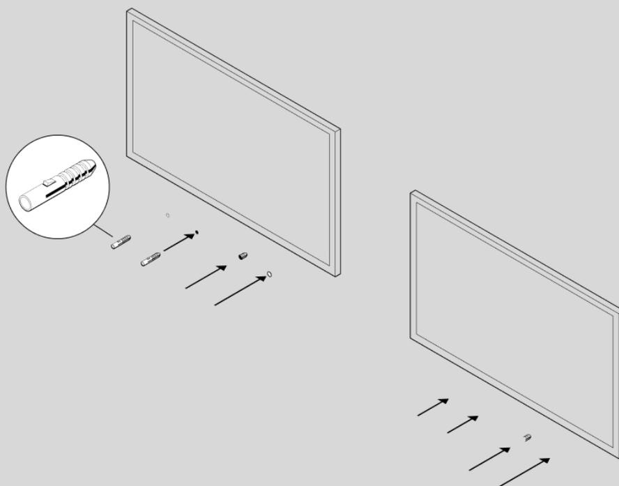
5. Setze die Halterung auf die Wand und ziehe die Wandschrauben locker an, um die Halterung zu befestigen. Überprüfe mithilfe einer Wasserwaage und ziehe die Schrauben dann fest an.
