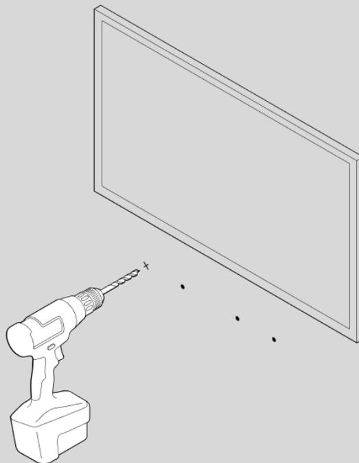
4. Setze die Wanddübel ein und sichere sie (verwende die Dübel nicht, wenn du in Holz bohrst).
