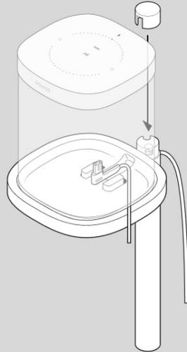
6. Drücke das Stromkabel von oben nach unten in die Kabelführung der Stange. Ziehe das überschüssige Kabel nach unten.
