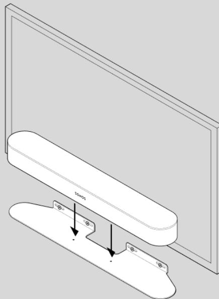
8. Befestige die Beam mithilfe der Montageschrauben an der Halterung.
