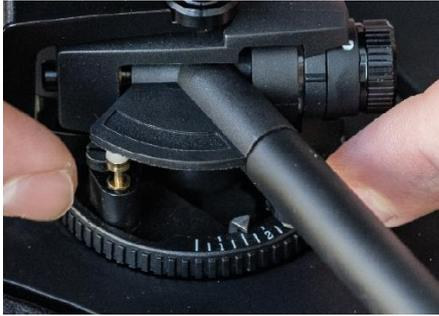
Stellen Sie das Anti-Skating ein, indem Sie den Anti-Skating-Einstellung (4) auf die gewünschte Stufe drehen. Das Anti-Skating wird in der Regel auf die gleiche Stufe wie die Auflagekraft eingestellt.
