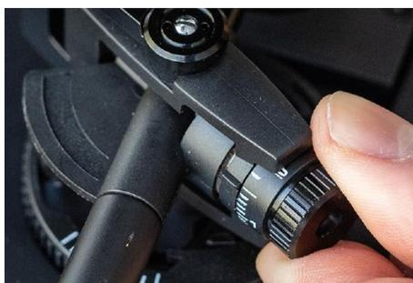
Sobald der Tonarm waagrecht ist, setzen Sie ihn wieder in seine Halterung. Drehen Sie das Einstellrad für die Auflagekraft (3), um die gewünschte Auflagekraft einzustellen.
