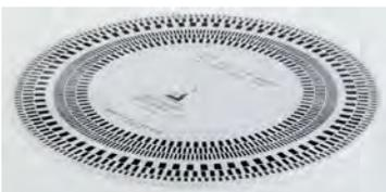
Zur Einstellung der exakten Geschwindigkeit wählen Sie bitte zunächst die richtige Plattenseite. Die Seite mit den breiten Strichen (siehe Bild) eignet sich zur Drehzahlregulierung mit jeder herkömmlichen Lichtquelle. Hier ist es möglich auch bei unterschiedlichen Netzspannungen von 50 Hz (Europa) mit Hilfe der äußeren Skala, oder bei einer Netzspannung von 60 Hz (USA) die Geschwindigkeit Ihres Plattenspielers einzustellen.
