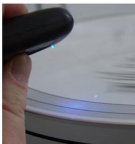
Mit Hilfe des *Speed Lights* (Art.Nr. AC039, [www.analogshop.de](http://www.analogshop.de)) erreichen Sie eine Einstellung der genauen Geschwindigkeit, unabhängig von der Netzfrequenz Ihres Landes. Das blaue 300 Hz Licht dieser externe Lichtquelle ist auch von eventuellen Netzschwankungen unabhängig, die bei normalem Licht das Ergebnis verfälschen könnte. Die 300 Hz des *Speed Lights* werden durch einen quarzstabilisierten Oszillator erzeugt und ermöglichen somit eine sehr exakte Einstellung.
