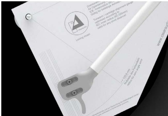
Abb. 10: Parallelität des Tonarmes
