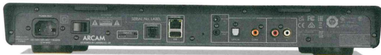
**KONTAKTFREUDIG:** Hier bekommt man alles, was das Herz begehrt. Der Netzwerk-Streamer ST5 bietet analoge und digitale Ausgänge, Letztere sowohl optisch als auch im Koax-Format. Anschluss ins heimische Netzwerk findet der ST5 per Ethernet oder drahtlos über WLAN. Einen USB-Host-Port gibt es ebenfalls.
